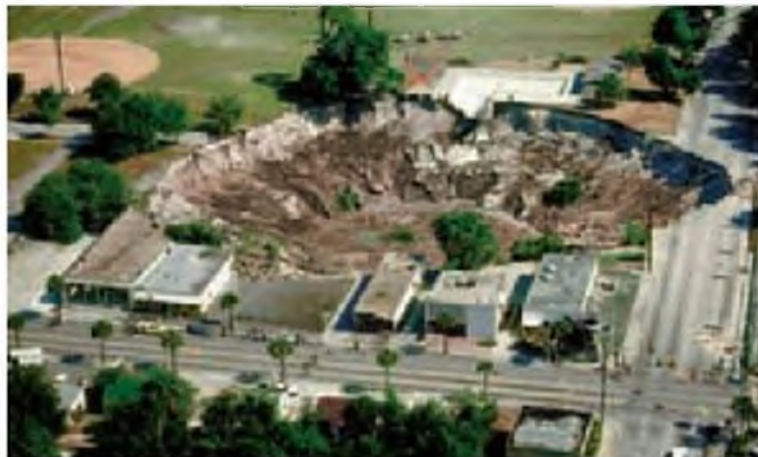
▲ Figura 17.17 Formación de hundimientos. Se forma un vacío subterráneo conforme la piedra caliza, \text{CaCO}_3(s) , se disuelve. El colapso del terreno superior en una cavidad subterránea ocasiona la formación de un hundimiento. El gran hundimiento que aparece en esta fotografía ocurrió en Orlando, Florida y destruyó varias casas y parte de una vía rápida.
